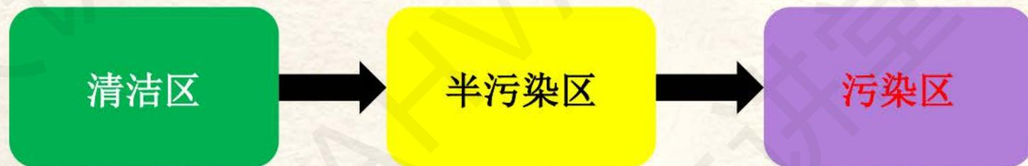
方舱医院“三区二通道”的压力梯度原则为：**污染区必须为负压**，同时相邻区域之间应设置相应的**卫生通过或缓冲间**，同时将清洁区和半污染区与污染区各区之间共用的风管、风口和设备及管道（井）等进行**封堵**，防止不同分区的气流交叉流动。
